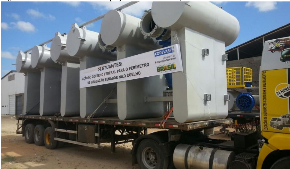
Figura 102 - Estrutura flutuante de captação Polo Nilo Coelho, Petrolina - PE. Casa Nova - BA.
